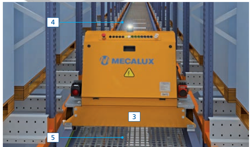
Detalle la lanzadera y del piso de mantenimiento.
