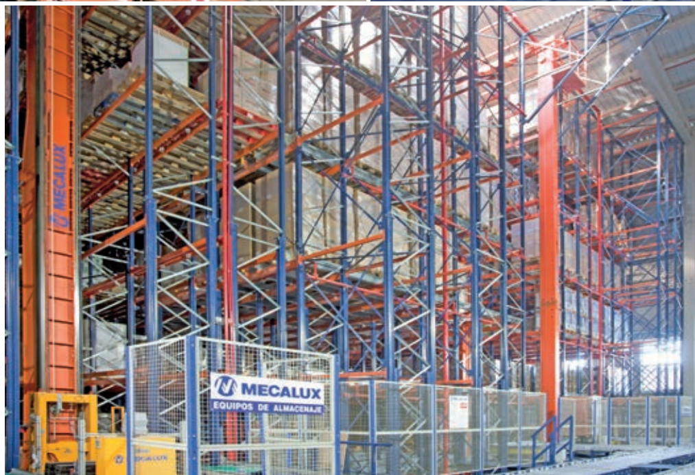
Almacén automático con Pallet Shuttle automático (3) para la preparación de pedidos y almacén automático de doble profundidad (4).
